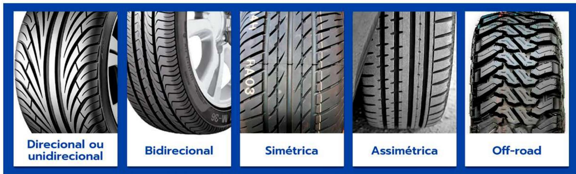
Os tipos de banda de rodagem se diferenciam pelos desenhos dos sulcos, profundidade destes, tipos e função dos pneus. Elas são:
